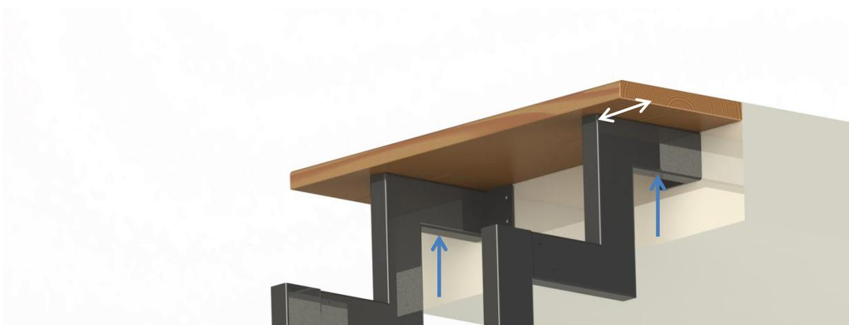
Закрепляем ступени к каркасу с помощью саморезов 6x110. Дубовые ступеньки рекомендуется предварительно просверлить тонким сверлом, с ограничителем длины.
