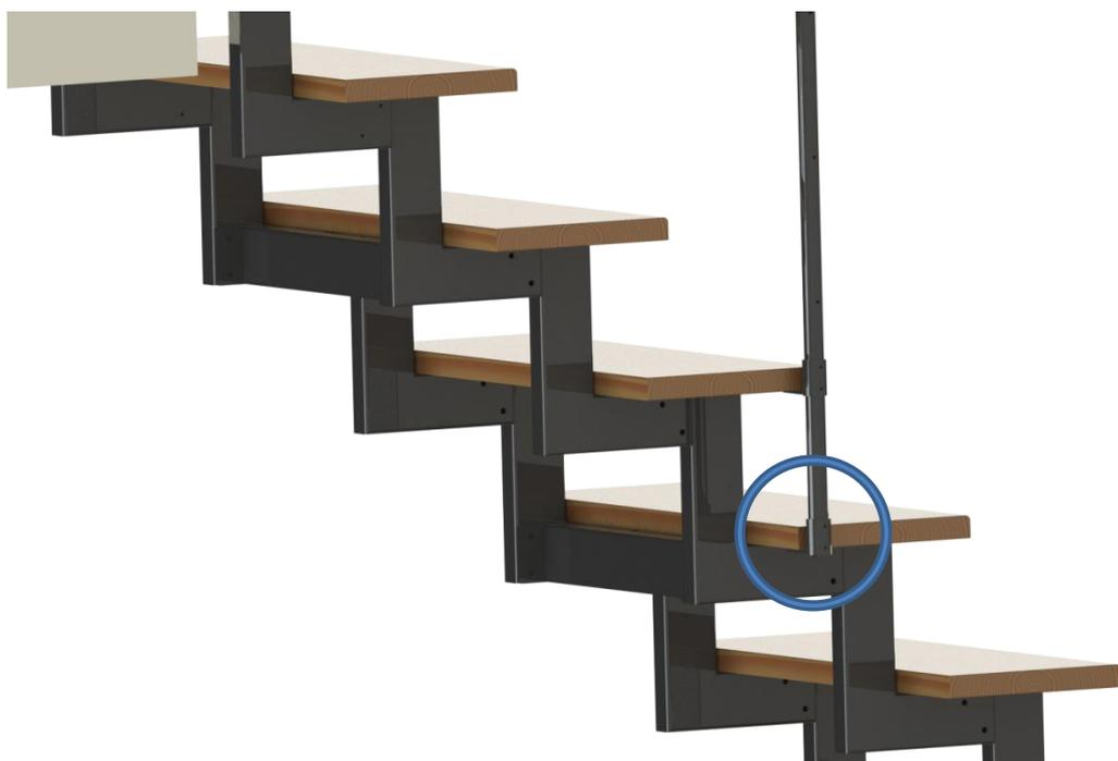
Фиксируем боковые крепёжные элементы со стойками с помощью заклёпок.
